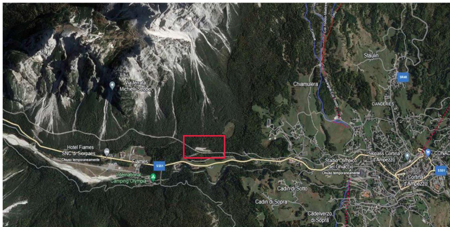
Foto aeree dell'area facente parte del comune di Cortina D'Ampezzo soggetta a rischio idrogeologico. In giallo, Strada Statale Di Allemagna, nel riquadro rosso la vasca di raccolta del Debris Flow oggetto del monitoraggio
